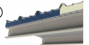
Remate tipo Caballete Externo e Interno Metecno, o equivalente
